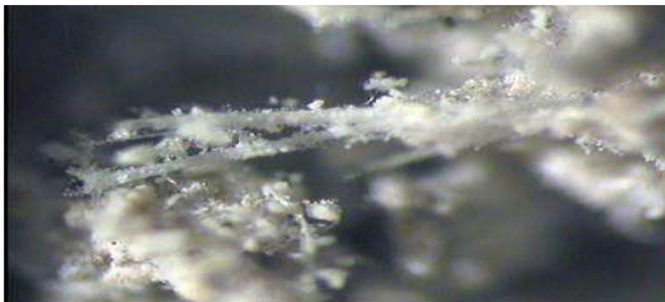
Ryc. 3 Zdjęcie mikroskopowe materiału zawierającego azbest – widoczna struktura rakotwórczych włókien – zdjęcia [2]
