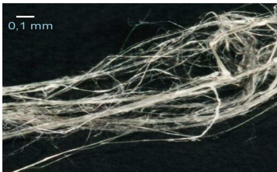
Ryc. 2 Zdjęcie mikroskopowe materiału zawierającego azbest – widoczna struktura rakotwórczych włókien – zdjęcia [2]
