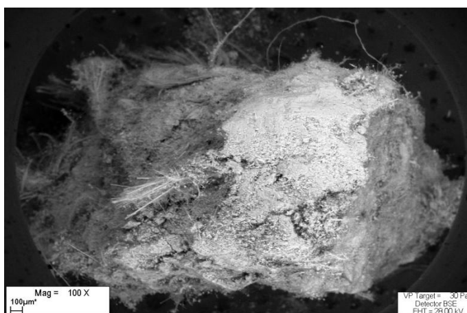
fot. 1 komputer skaningowy z detektorem BSE, z podziałką wielkości w lewym dolnym rogu pokazującą dokładność pomiaru wielkości badanego włókna azbestu(3)
